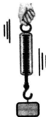
图3-6-1 用手提着弹簧测力计的吊环向上、向下运动
